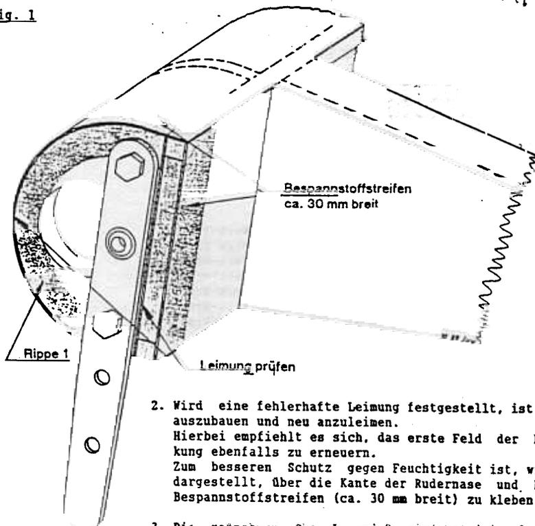
2. Wird eine fehlerhafte Leimung festgestellt, ist die Rippe 1 auszubauen und neu anzuleimen. Hierbei empfiehlt es sich, das erste Feld der Nasenbeplankung ebenfalls zu erneuern. Zum besseren Schutz gegen Feuchtigkeit ist, wie in Fig. 1 dargestellt, über die Kante der Rudernase und Rippe 1 ein Bespannstoffstreifen (ca. 30 mm breit) zu kleben.
