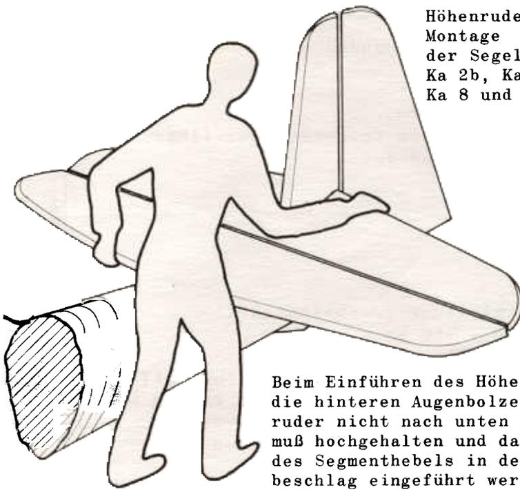
Beim Einführen des Höhenleitwerkes in die hinteren Augenbolzen darf das Höhenruder nicht nach unten hängen, sondern muß hochgehalten und das Kugellager des Segmenthebels in den U-Führungsbeschlag eingeführt werden!
